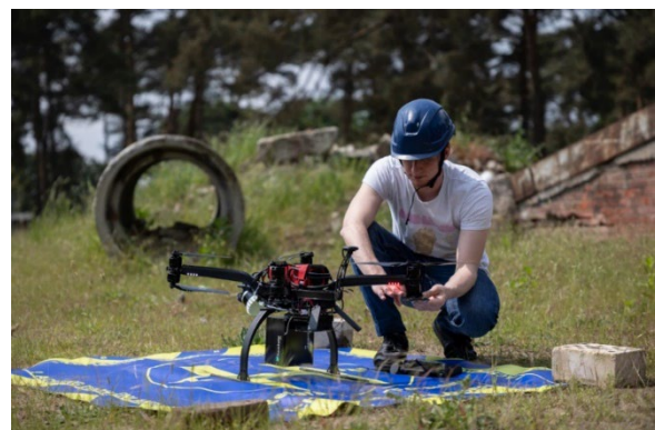
Vorbereitung einer Drohne zur Gasmessung und 3D-Kartierung © THW/ Yann Walsdorf
