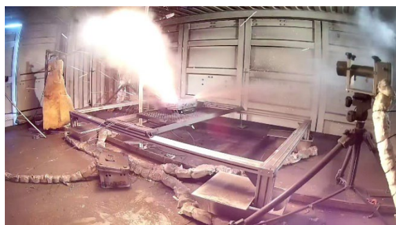
Versuch zum thermischen Durchgehen eines 2,65-kWh-Automobilantriebsmodul im Demonstrator.
